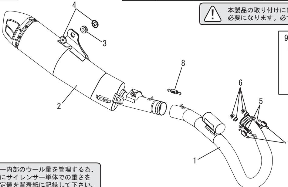
**!** 本製品の取り付けには、別途純正ガスケットが必要になります。必ず新品を用意して下さい。
